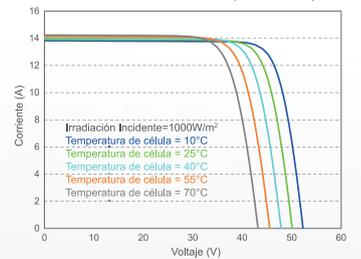
**I-V/P-V Curva con Diferente Irradiación (555W)**
